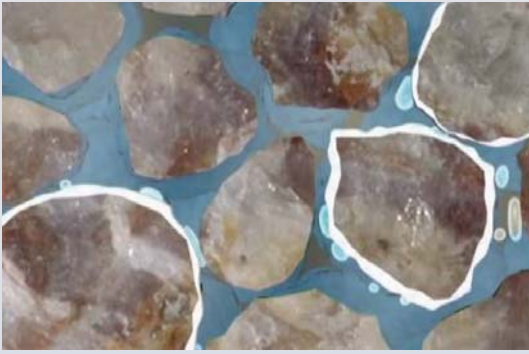
Figure 2 CO 2 dense remontant (bulles bleu clair), se dissolvant et réagissant avec les grains de la roche, ce qui entraîne la précipitation de minéraux carbonatés à la surface des grains (blanc).
