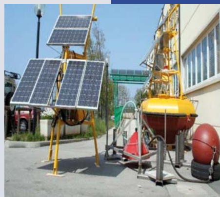
Figure 2 Bouée de monitoring avec panneaux solaires, flotteurs et dispositif destiné à prélever des échantillons de gaz sur le fond marin.
