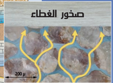
شكل 1 يميل الـ CO 2 المحقون، والذي يعتبر أخف من الماء، إلى الارتفاع ويتم إيقافه من قبل طبقات الصخور العلوية غير منفذة.
